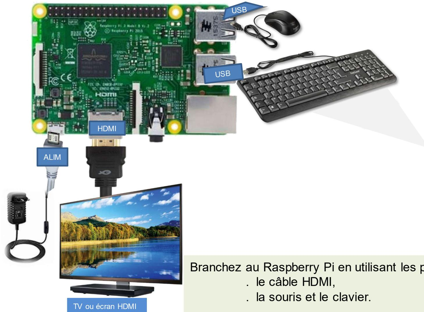
Branchez au Raspberry Pi en utilisant les ports HDMI et USB:
