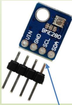
Souder les 4 broches courtes du connecteur au capteur
