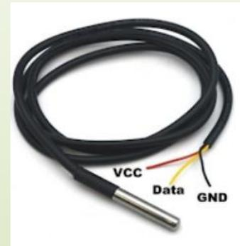
La Sonde DS18B20 se connecte sur la broche GPIO4 de la Raspberry avec une résistance de  $4.7\text{k}\Omega$  entre GPIO4 et l'alimentation.
