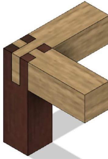
**NOTA:** Pour un assemblage sans jeu, il est conseillé que la cote de la pièce femelle soit **0,2 mm** inférieure à celle de la pièce mâle (c'est suivant votre imprimante, faire des essais avant)
